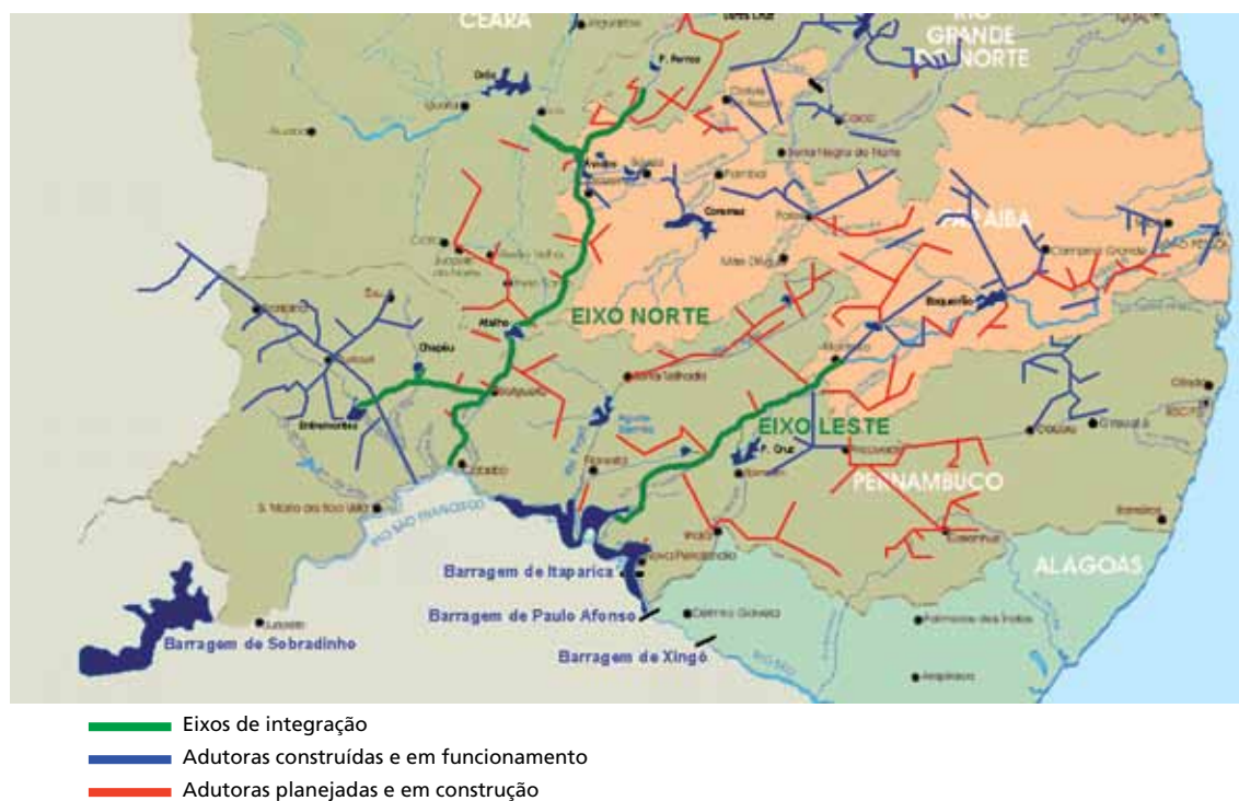
FIGURA 1 Projeto de integração do rio São Francisco com as bacias hidrográficas do Nordeste Setentrional
