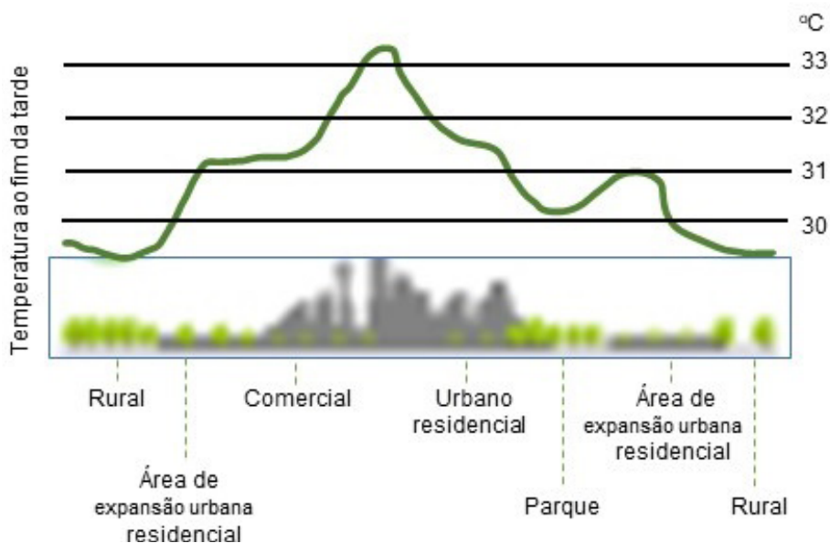
FIGURA 2 Perfil térmico de uma cidade em que é evidenciada uma ilha de calor urbana
