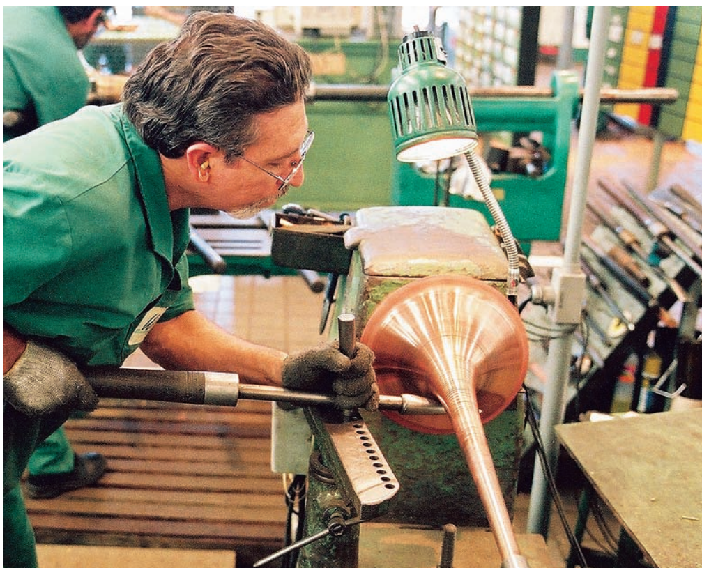
lançamento mundial em 2006. Abaixo, o trabalho em tornos artesanais, que dá a forma inicial aos instrumentos
