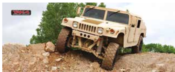
Figura 4 Veículo de combate leve HMMWV com o sistema de suspensão TAK-4
